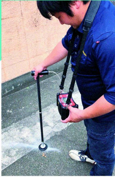
精密機器を使い、漏水の場所を探す専門業者
